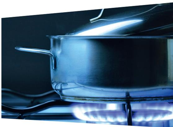
Il faut aussi nettoyer régulièrement les brûleurs de la gazinière qui peuvent s'éteindre si les orifices sont encrassés. Une flamme bleue doit être visible dans chaque orifice du brûleur (le dessous d'une casserole noircie ou une flamme orange sont les signes d'une combustion mal réglée).
